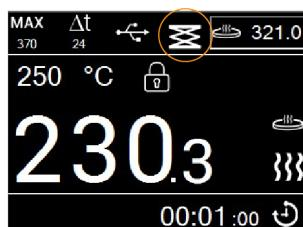
Im Falle einer Unterbrechung der Datenverbindung zwischen Hebebühne und Magnetrührer erscheint auf dem Display des Magnetrührers die Warnmeldung [73: Hebebühne keine Verbindung] und das Symbol [Hebebühne angeschlossen] erlischt.
