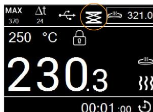
Dans le cas d'une rupture de la connexion des données entre le support-élévateur et l'agitateur magnétique, le message d'avertissement [73 : support-élévateur : aucune connexion] apparaît sur l'écran de l'agitateur magnétique et le symbole [support-élévateur connecté] disparaît.
